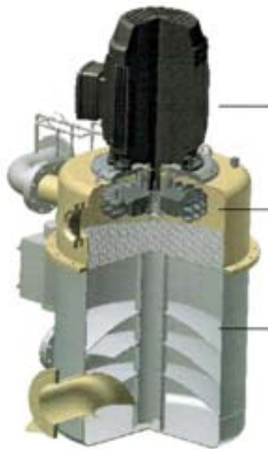
Bild 7: Neuartige Gegendruck-Pelton-Turbine mit Luftpolster Kompressorbetrieb über dem Unterwasserspiegel, damit das Pelton-Lauftrad nicht im Wasser wadet. (Quelle: Bluewater, Schafisheim)
